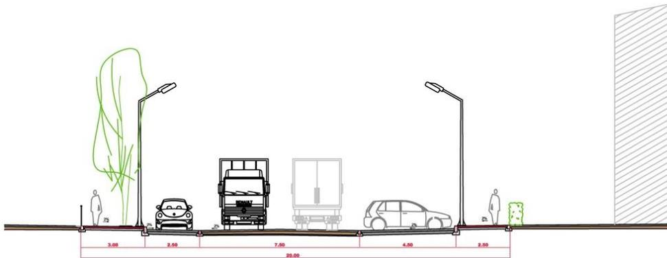
Ilustración 44. Sección tipo de viario de distribución
